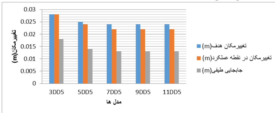
شکل ۱۷ نتایج خروجی های تغییر مکان ها در سازه های دارای میراگر در دهانه های کناری دارای دهانه ۵ متری
