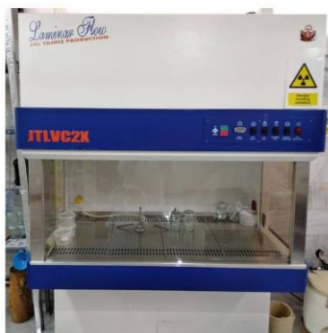
شکل ۳-۲ هود لامینار مدل کلاس II مورد استفاده در آزمایشگاه
